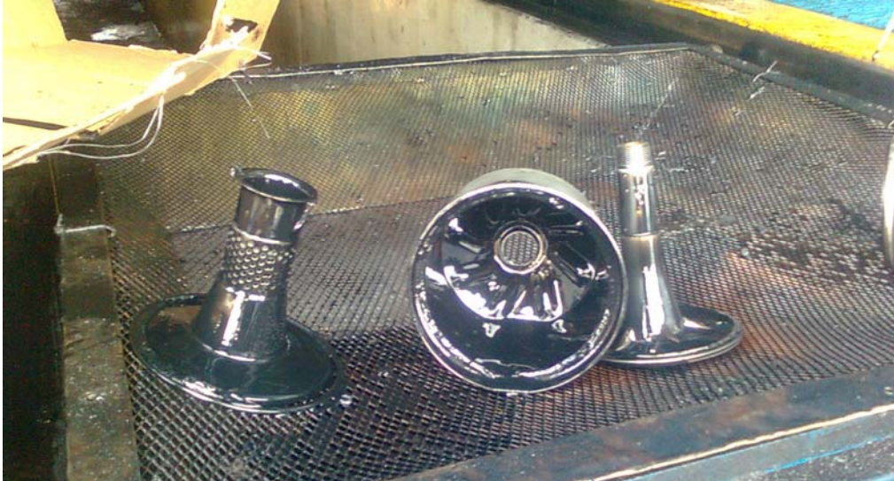
Los componentes del filtro no muestran las capas de lodo, pegadas a su superficie. (Bus #20 equipado con puraDYN hace 20 mil kilómetros).
