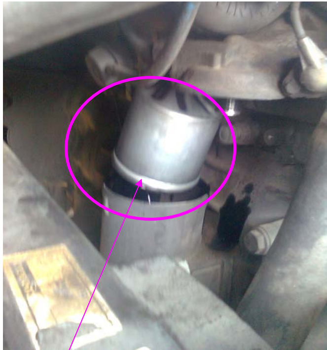
Estado en el que sale el filtro centrífugo de su carcaza, nótese la limpieza del mismo (Bus #20 equipado con puraDYN hace 20 mil kilómetros)
